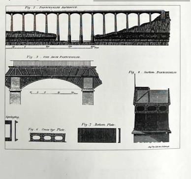
Aqueduc de Pontcysyllte, détails de structure, coupes et élévation.
