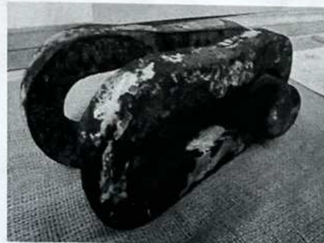
図-8 ハンガーの支持金物とチェーン継手の楕円形リング(下)(2014.11)
